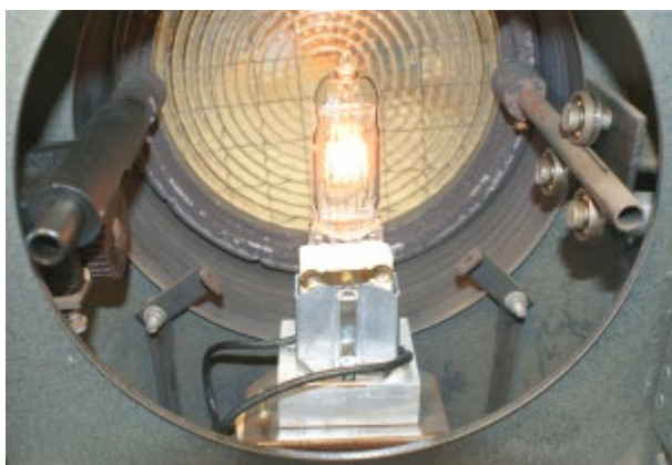
Obr.33 Lampová skříně reflektoru GHR 1000 s halogenovou žárovkou T/19 (230 V/1 000 W)
