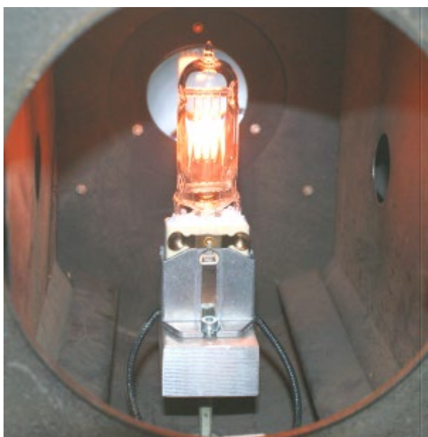
Obr.29 Lampová skříně reflektoru EB 12551 s halogenovou žárovkou T/19 (230 V/1 000 W)
