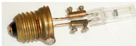
Obr.26 Adaptér E27 pro HPZ a HLX
