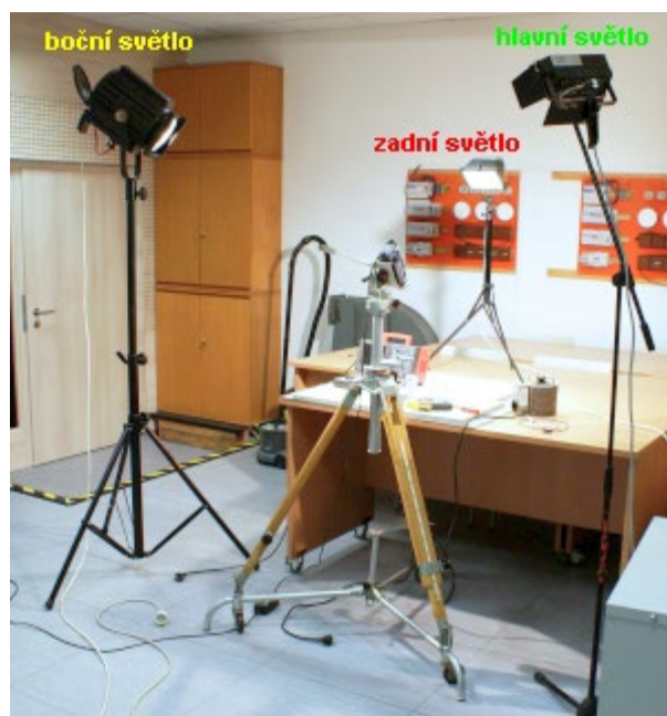
Obr.3 Základní uspořádání osvětlení
